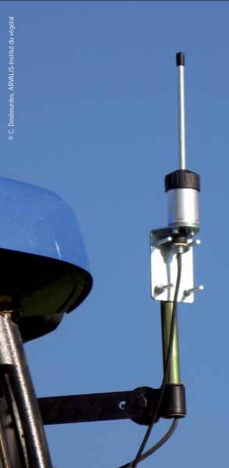
Radio bidirectionnelle installée sur un tracteur.
