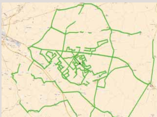
Figure 6 : Cette première phase a permis d'identifier les zones où la transmission par GPRS était utilisable (en vert) et les zones où il était nécessaire d'installer des radios bidirectionnelles.
