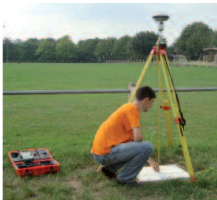
Figure 2. Exemple d'installation d'un récepteur GNSS en mode statique.
