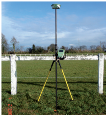
Figure 3. Exemple d'installation d'un récepteur GNSS en mode statique.
