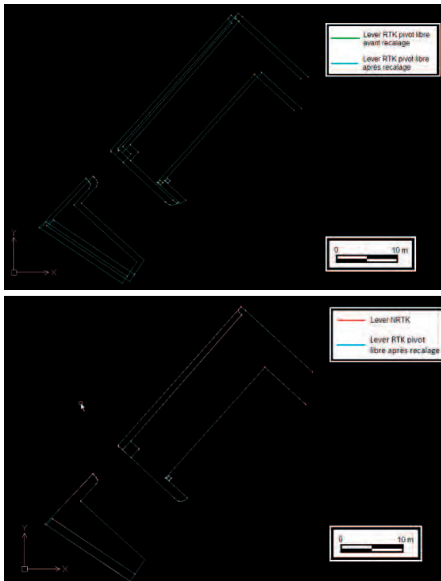
Figure 6. Comparaison entre le lever obtenu en mode "RTK pivot libre" en fixant arbitrairement une position WGS84 au pivot (en vert) et le même lever suite à la mise en référence du pivot dans le RGF93 (en bleu). A titre indicatif, le lever NRTK est également représenté (en rouge).
